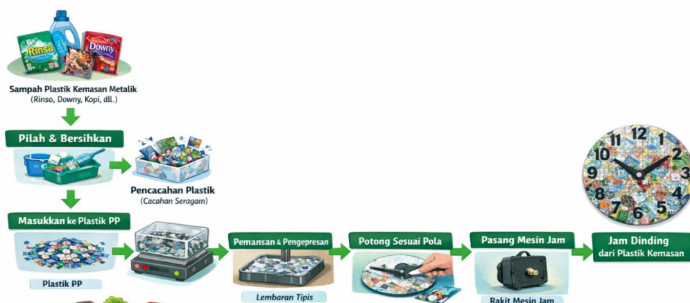
Gambar 3. Diagram Alir Pembuatan Produk Kerajinan dari Pengolahan Limbah Plastik.
