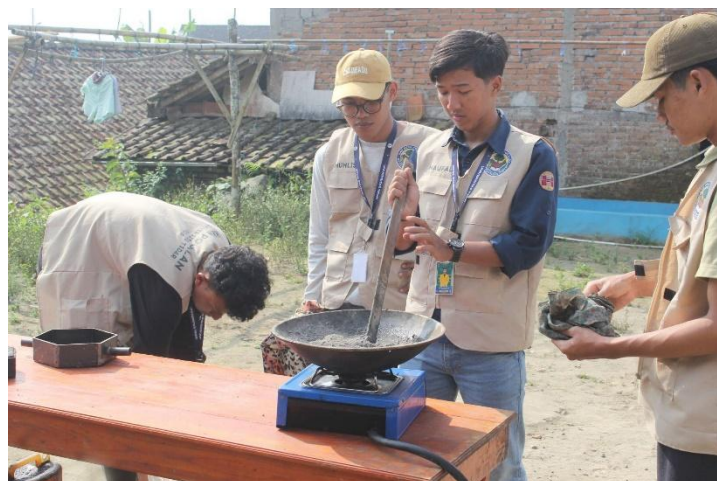
Gambar 5. Proses Pelelehan Sampah plastik.
