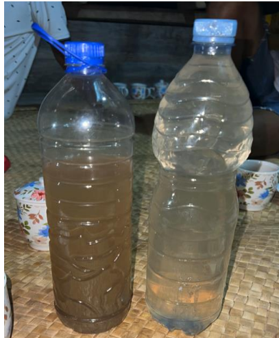
Gambar 7. Kondisi air sebelum dan sesudah diolah di menara filter air
