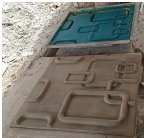
Gambar 2. Cetakan Roster Dinding di UMKM Desa Cadassari.
