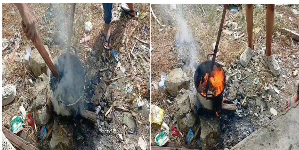
Gambar 1. Proses pelelehan plastik yang akan dijadikan paving block
