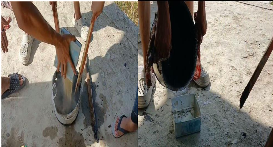
Gambar 2. Proses pembuatan paving block
