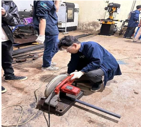
Gambar 3 Proses Pemotongan Material.
