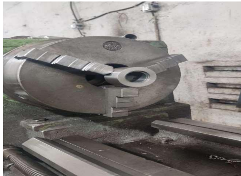
Gambar 5. Proses Pembubutan Material SKD 11.
